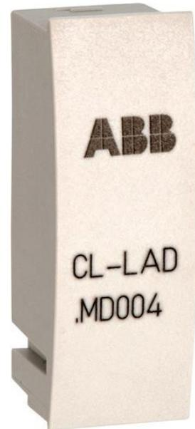
Le CL-LAD.MD004 est un module de mémoire de la CL de la gamme. Il a une taille de mémoire de 256 ko et est connectable sur l'affichage des modules de base.
