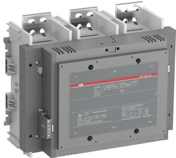
3-phase Contacteur adapté à diverses applications telles que le démarrage du Moteur, de l'Isolation, de By-pass et de la Distribution de l'application jusqu'à 1000 V. Exploité avec le contrôle de l'ensemble de la plage de tension de 100 à 250 V AC/ DC
