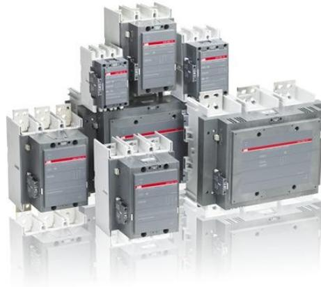
Un 3 pôles du Contacteur adapté pour DC-1 pour les applications où les trois pôles doit être connecté en série à 1 pôle de configuration jusqu'à 1000 VDC. Exploité avec le contrôle de l'ensemble de la plage de tension de 100 à 250 V AC/DC
