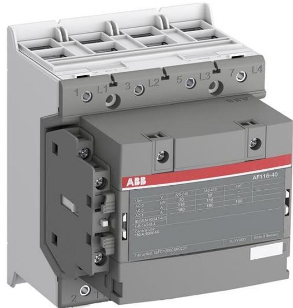
3-phase Contacteur adapté à diverses applications telles que le démarrage du Moteur, de l'isolement, de By-pass et de la Distribution de l'application jusqu'à 690 V. Exploité avec le contrôle de l'ensemble de la plage de tension 24-60 V, 50 et 60 Hz, 20 À 60 V DC
