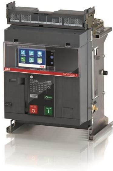
PARTIE mobile POUR C. DISJONCTEUR SACE EMAX2 E1.2B 1600 à TROIS PÔLES AVEC L'ÉTAT SOLIDE à LIBÉRATION EN AC EKIP/HI-TOUCH-LSIG R 1600 ÉQUIPÉ: 4 CONTACT AUXILIAIRE ET C. DISJONCTEUR EN POSITION OUVERT-FERMÉ
