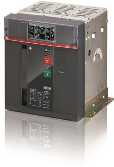
C. DISJONCTEUR SACE EMAX2 E2.2H 2500 FIXE à TROIS PÔLES AVEC BORNES à l'ARRIÈRE HORIZONTAL ET à l'ÉTAT SOLIDE à LIBÉRATION EN AC EKIP/DIP-LSI R 2500 ÉQUIPÉ: 4 CONTACT AUXILIAIRE ET C. DISJONCTEUR EN POSITION OUVERT-FERMÉ
