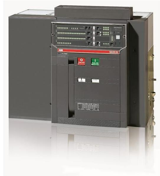
SACE EMAX DISJONCTEUR E3H 2500A QUATRE PÔLES FIXE AVEC BORNES à l'ARRIÈRE HORIZONTALE de SURINTENSITÉ de presse PR121/P-LSI R2500 ÉQUIPÉ: 4 CONTACT AUXILIAIRE ET C. DISJONCTEUR EN POSITION OUVERT-FERMÉ
