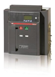
SACE EMAX DISJONCTEUR E3H 2500A TROIS PÔLES FIXE AVEC BORNES à l'ARRIÈRE HORIZONTALE de SURINTENSITÉ de presse PR122/P-LI R2500 ÉQUIPÉ: 4 CONTACT AUXILIAIRE ET C. DISJONCTEUR EN POSITION OUVERT-FERMÉ
