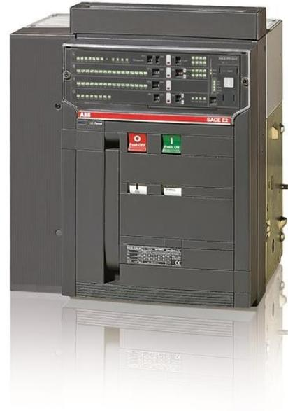
SACE EMAX DISJONCTEUR E2L 1600A QUATRE PÔLES FIXE AVEC BORNES à l'ARRIÈRE HORIZONTALE de SURINTENSITÉ de presse PR121/P-LSI R1600 ÉQUIPÉ: 4 CONTACT AUXILIAIRE ET C. DISJONCTEUR EN POSITION OUVERT-FERMÉ
