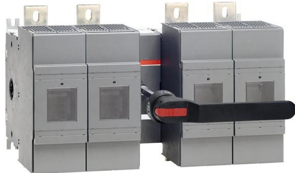
Y compris les terminaux de kit de culasse, d'un noir en plastique de la poignée et de l'arbre en tant que norme. La poignée est IP65, NEMA 1, 3R, 12 protégés, padlockable en position ARRÊT et de verrouillage de la porte en position. La tige est réglable pour une gamme de profondeurs d'installation. Fusible normes UL 248.
