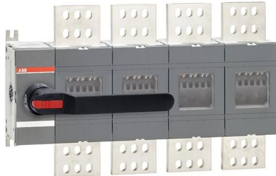
Y compris les terminaux de kit de culasse, d'un noir en plastique de la poignée OHB200J12P et de l'arbre OXP12x280 standard. La poignée de protection IP65, padlockable en position ARRÊT et de verrouillage de la porte en position. La tige est réglable pour une gamme de profondeurs d'installation.
