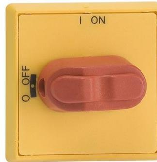
Sélecteur de type de poignée, Indication I-O et on-OFF, pour diamètre d'arbre de 6 mm, porte de forage de 22,5 mm. IP 54 poignée, NEMA 1, rouge-jaune, OT16...80F
