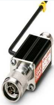
Für TETRA-Anlagen (380 MHz - 470 MHz), Schirm erdpotenzialfrei, Anschluss: Typ N
