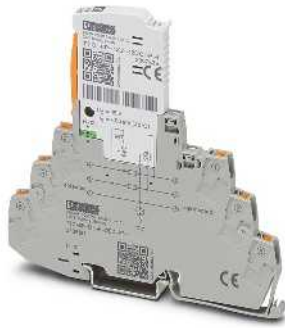
Doppelader (Loop), erdpotenzialfrei, Anschluss 3/6 über Gasableiter geerdet, z. B. für 4 ... 20 mA Stromschleife
