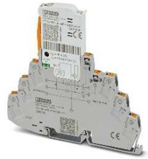
3-Leiter mit gemeinsamem Bezugspotenzial, Anschluss 3/6 über Gasableiter geerdet, steckbar
