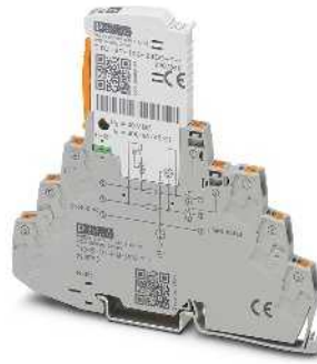
Doppelader (Loop), erdpotenzialfrei, Anschluss 3/6 über Gasableiter geerdet, mit Messertrennung, z. B. für 4 ... 20 mA Stromschleife
