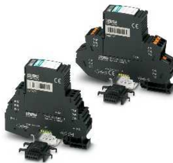
3-Leiter-Schutz für Feldbus und serielle Schnittstelle, Anschluss 9/10 direkt geerdet
