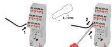
Câblage embrochable sans besoin de tournevis
