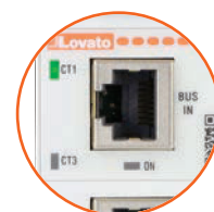
Voyants LED de signalisation d'autoconfiguration et accouplement corrects
