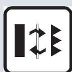
Per la rilevazione di oggetti trasparenti come bottiglie in PET o fogli di Mylar, è possibile usare un modello a sbarramento polarizzato a bassa isteresi (che rileva variazioni di segnale ridotte).
