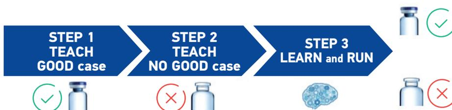
Il sensore è particolarmente adatto per tutte le applicazioni in cui è necessario risolvere il rilevamento tra due condizioni ben specificate dell'oggetto, come la presenza o l'assenza di una specifica caratteristica come una etichetta o l'orientamento rispetto a due lati differenti dell'oggetto target, tramite l'apprendimento delle due classi GOOD e NO GOOD.
