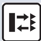
Proiettore e ricevitore sono ubicati nello stesso corpo. Grazie a un riflettore prismatico, il fascio di luce emesso viene riflesso sul ricevitore e l'oggetto viene rilevato quanto lo interrompe.
