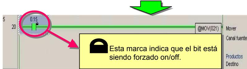
Una vez que los bits/bobinas se fuerzan on/off, los estados forzados se mantienen hasta que sean cancelados, o se proceda de forma inversa para on/off. Los estados no cambian por causa de una entrada externa o del resultado operacional del programa. Además, las operaciones de forzado no están habilitadas cuando el PLC se encuentra en el modo Run.
