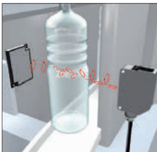
Uso del efecto de doble reflexión en PET para obtener una mayor estabilidad en la detección (modelos optimizados para PET)
