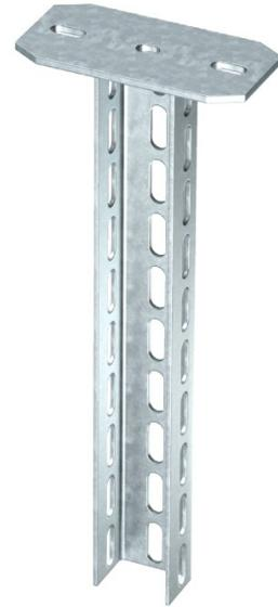
Para la fijación horizontal de techos de hormigón y vigas de acero. Para soporte de ancho de 400 mm o más, o si el soporte está montado en el extremo de una suspendido de apoyo, se recomienda el uso del espaciador, tipo de DSK 61.
