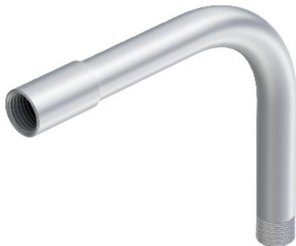
Curva de 90° para la instalación eléctrica, tuberías de acuerdo a la norma EN 61386-1 con extremos roscados DIN EN 60423. Con rebaba-libre de la pared interna. Una conexión manga ya se atornillan a cada tubo doble.
