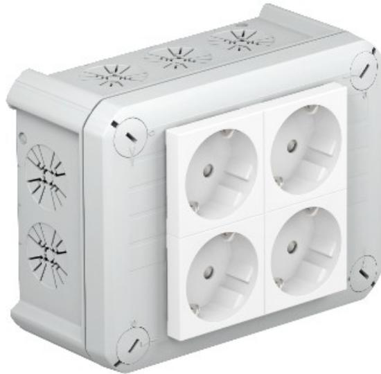
Las cajas de conexiones están hechas de un termoplástico de polímero de polipropileno y están equipadas con alivio de tensión de las entradas. Estas entradas pueden ser penetrado directamente con los cables. La estructura especial de la apertura significa que los cables no puede ser eliminado sin querer. Adecuado para diámetros de cable de entre 7 y 21 mm.
