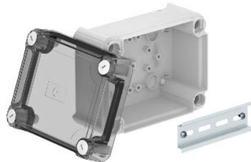
Las cajas de derivación que consisten en material termoplástico. La parte inferior de las piezas están hechas de resistente a los impactos de polipropileno, la tapa de la caja está hecha de, muy resistente, de policarbonato resistente al impacto. La alta resistencia al impacto IK 10 a -5°C muestra este también.
