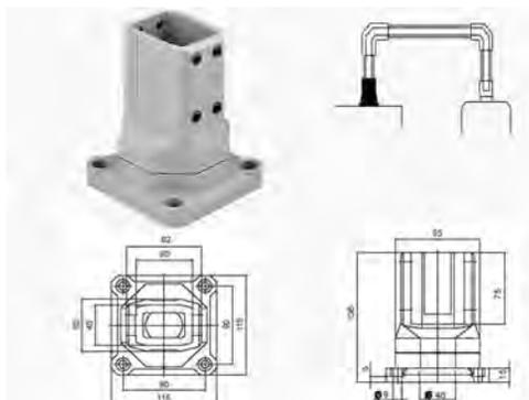
**Descripción:** Soporte giratorio base para sistema SL, ángulo de rotación 300° con limitador.
