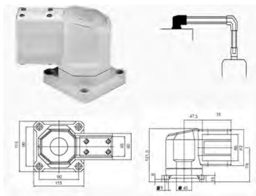
**Descripción:** Unión a base horizontal para sistema SL, ángulo de rotación 300° con limitador. Acceso de cable con tapa plástica de fijación rápida.
