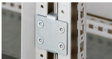
**Descripción:** Soportes para fijarlos en los taladros exteriores del frente y posterior del marco del armario, asegurando la alineación de los armarios con función de "auto-espaciado". Presenta la ventaja de conexión de tierra directa entre las estructuras de los armarios.
