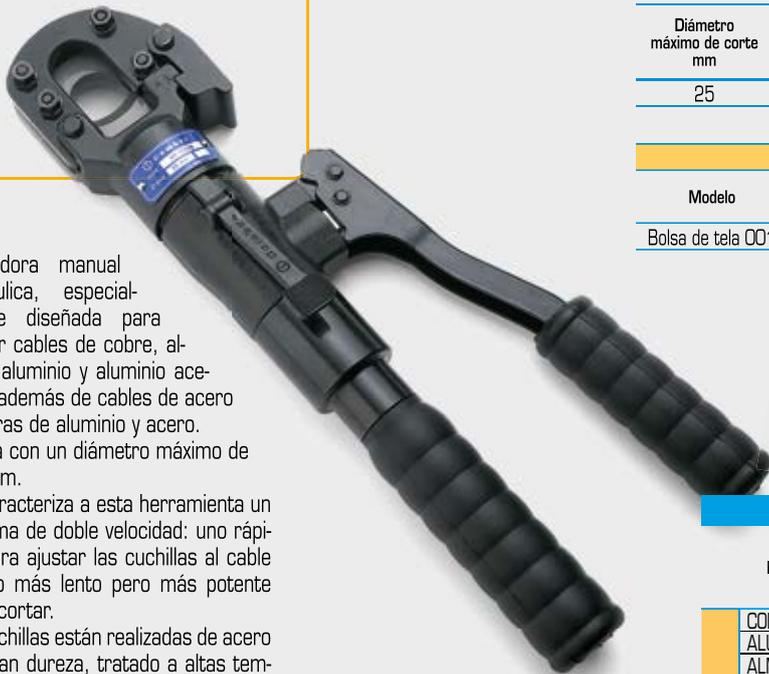
Cortadora manual hidráulica, especialmente diseñada para cortar cables de cobre, al-drey, aluminio y aluminio acerado además de cables de acero y barras de aluminio y acero. Opera con un diámetro máximo de 25 mm.
