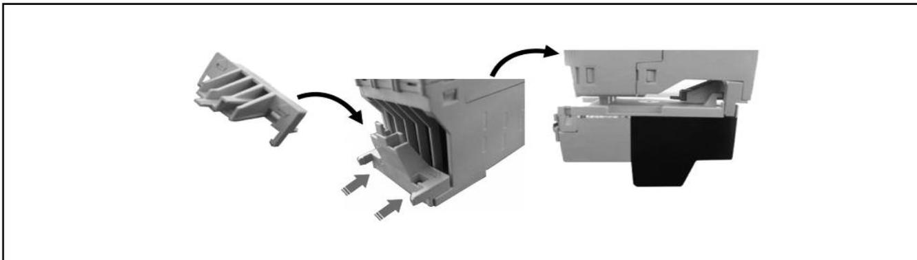
Adaptador de relé de sobrecarga del motor\*
