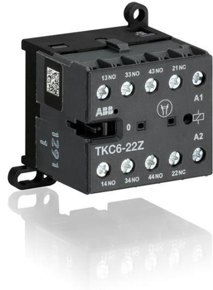
El TKC6-22Z mini contactor relé es un compacto de 4 polos del contactor relé con terminales de tornillo. Son ideales para aplicaciones donde la fiabilidad es una necesidad y el espacio está en un premio. Mini contactores relés se utilizan en residencial buldings, edificios comerciales e industriales para la conmutación de las señales de control de hasta 3 a / 400 V (AC-15). Otras características son el silencioso y hum-libre de la bobina y un conmutador de indicación de posición.
