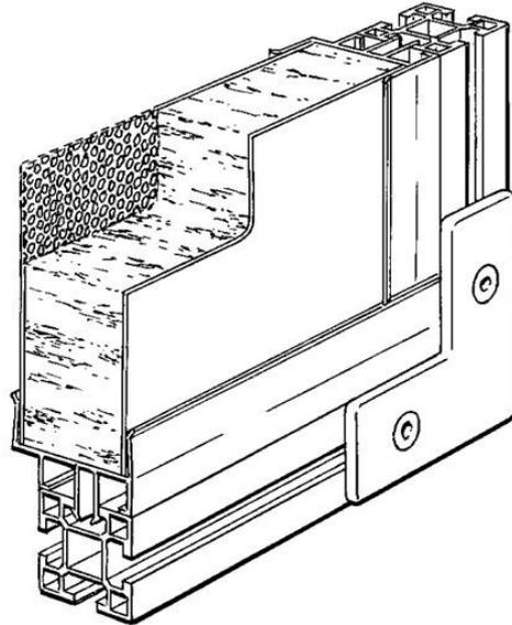
Montaje de perfil de 50mm de absorción de sonido de los paneles. Natural de Aluminio anodizado, max longitud de 6000m m
