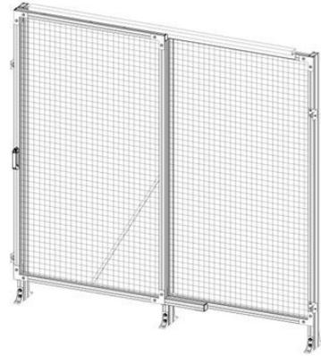
Rápida de la Guardia E slidingdoor sección con 44x44/44x88mm perfiles. Incluyendo los componentes de los perfiles, malla soldada, suspensión de ruedas, rectores de los componentes de piso, soportes y netlocks. La altura Total de 2200m m, anchura de la puerta 1100 mm c-c de los perfiles.
