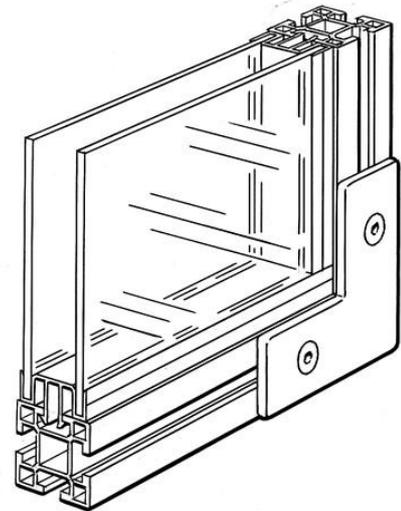
Montaje en perfil doble láminas de policarbonato(2x5mm). Natural anodizado de Aluminio, corte a la longitud, max 2000mm
