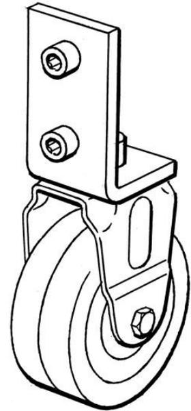
Soporte fijo de la rueda, incluyendo el ángulo del soporte. Diámetro de la rueda de 75 mm, altura 95 mm. Carga máxima de 70 kg
