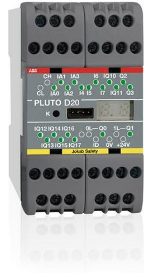
PLC de seguridad con Plutón bus de seguridad y de las entradas analógicas. Totalmente de 20 e/S: 4 combinados módulos de entradas analógicas y entradas digitales + 4 entradas de seguridad + 8 no a prueba de fallos salidas/entradas de seguridad + 2 individualmente módulos de salidas de relé + 2 individualmente a prueba de fallos salidas de transistor. Analógica rango de entrada de 0-10V/4-20mA.
