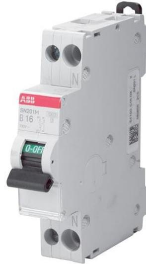
El SN201 serie disyuntor miniatura es una 1P+N de un solo módulo de dispositivo para la protección de circuitos contra sobrecargas y corto circuito. Es adecuado para la aplicación en la final de la distribución y protección de largas longitudes de cable en TN y los sistemas de
