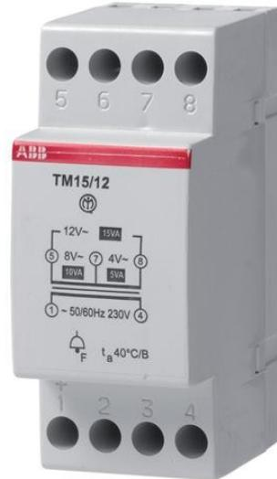
Estos transformadores, con seguridad muy baja tensión secundaria (SELV), son adecuados para la conducción de cargas que requieren un suministro discontinuo.
