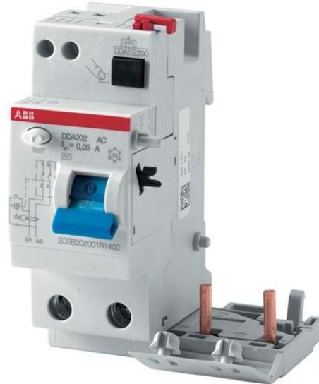
El RCD bloque DDA200 de la serie es adecuado para la asamblea con Interruptores magnetotérmicos y diferenciales de la serie S200. Asegura la protección contra los efectos de la sinusoidal continua y alterna pulsante de la tierra de las corrientes de falla, la protección contra indirects contactos y protección adicional contra directo (con una sensibilidad = 30 mA) contactos. Aplicaciones: residencial, comercial, industrial.
