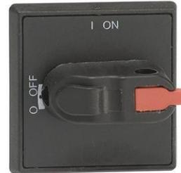
Selector de tipo palanca. Tornillo de montaje, la distancia entre los orificios de 36 mm. Indicación I-O y ON-OFF. No se separa del eje es necesario. Candado con un candado, ip54, NEMA 1, negro, OT16...40FT
