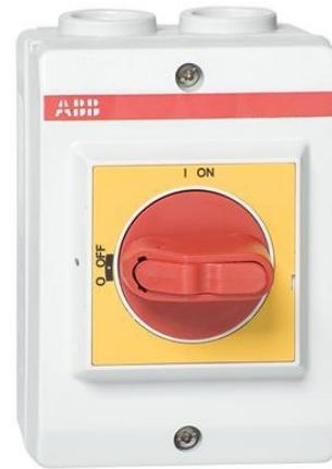
Cerrado el interruptor 3-p.400 V AC23A 10A AC22A 16A caja de Plástico IP65
