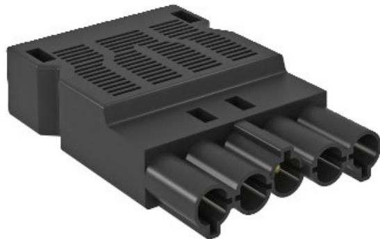
Часть разъем, 5-Контактный, Тип GST18i, с винтовым соединением для 1.5–2.5 мм<sup>2</sup>, одно-и тонкая проволока, с сброс напряжения, одно соединение на контакт, неоправленные, для кабелей использовать шнуры h05vv (Ø 9.5–13.5) и ным (Ø 10.5–13.5 мм), с замком, согласно натяжения в соответствии с VDE 0628 Блокировка должна быть спланирована, 250 В, 16 А.
