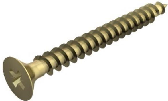
Закаленная сталь, electrogalvanised и желтой пассивации, а также Hostaflon-покрытием, потайная головка с крестовой головкой (Pozidrive Размер 2, за исключением Ø 6 мм Размер Pozidrive 3).
