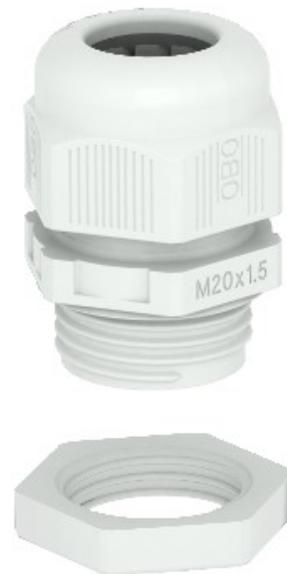
Наиболее быстрым и удобным способом обеспечения натяжения и герметичность кабельных вводов в распределительные коробки и корпуса с проверенной в-ТИК VM кабельные вводы из обо. С интегрированной уплотнительной кромки и специальной технологии обо ламели, Класс защиты ip68 достигается. Натяжения и герметичность были протестированы согласно EN 50262.
