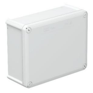
Распределительные коробки изготавливаются из термопластичного полипропилена полимера с закрытыми боковыми стенками. Это означает, что требуемые отверстия могут быть сделаны везде, где они необходимы. Плагин ЕДК сальники или кабельные вводы с подгаечниками могут быть вставлены в эти отверстия, чтобы позволить кабельные вставки.
