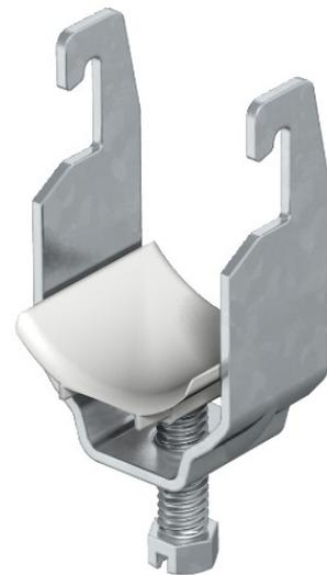
Подходит для всех профиль С рельсов с шириной шлица 18 и 22 мм. Также подходит для плоских, угловых и U стали 4 - 12 мм Толщина материала. ББС зажим и винт изготовлены из горячей оцинкованной стали. Полипропиленовый рукав давления, безгалогеновый, цвет светло-серый RAL 7035.
