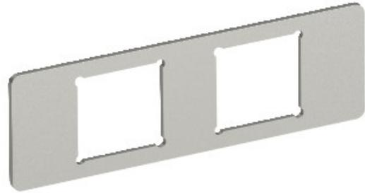
Монтажная пластина для приема двух подключение розетки для технологии передачи данных следующих типов: усилители ТАЙКО: Стандартный 110Connect, SL-это серия 110Connect и на Защелках, пож-закрутки; Бренд-Рекс: неэкранированный модуль; GG45; ТКМ разъем RJ мод; Нексане: волокна lanmark модуль с адаптером-зажим; компания siemon категории 6; 3M K6 и K10. Размеры монтажного проема в мм: 20.10 x 14.80.
