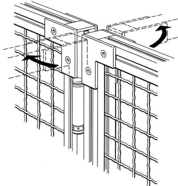
Двухсторонний шарнир. Цинк-покрынная сталь. Зазор дверь будет 28мм при установке
