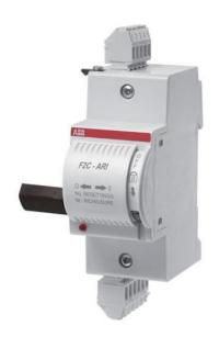
На завод f2c-A2 шунт поездки позволяет удаленное открытие устройства при подаче напряжения. Подходит для серии камеры f200 RCCBs и Aвдт DS201 и DS202C. Он может быть использован с автоматические выключатели серии SN201 посредством SN201-их интерфейс модуля. Он работает в диапазоне 110-415B собой.с. и 110-250B д.с.
