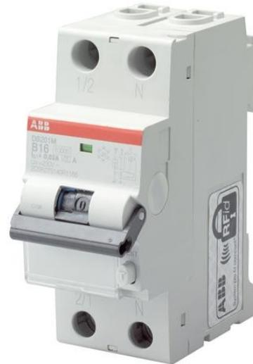
В DS201 серии АВДТ является 1П+N в два-модулей устройство для защиты конечного пользователя однофазных цепей от перегрузок и токов короткого замыкания, обеспечивает оптимальный компромисс между безопасностью и бесперебойностью службы, благодаря стойкости к нежелательным trippings; защита от непрямого контакта и дополнительная защита от непосредственного контакта (чувствительность = 30 мА); защита и изоляция резистивных и индуктивных нагрузок.
