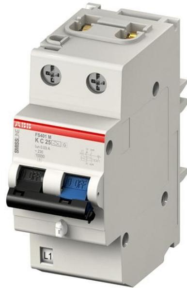
FS401KM-C16/0,03 остаточный настоящий автомат Защиты цепи с Предохранением от перегрузок по току 2 полюса 16А с характеристикой 10000 ~230/400В
