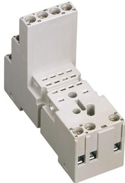
В CR-M4LS разъем от КР-М (миниатюра) реле диапазона. Логическая розетка подходит для CR-M реле 4 с ч/з (однополюсный на два направления) выходные контакты. Розетка имеет винтовые клеммы. Подключаемые модули функции, держатель и маркер доступны в качестве аксессуаров.
