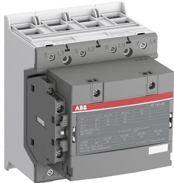
3-фазный Контакттор подходит для различных приложений, таких как запуск двигателя, изоляция, бай-пасс и приложения распределения, максимум до 690 в. эксплуатируется с широким диапазоном напряжения управления в диапазоне 250-500 В, 50/60 Гц и постоянного тока
