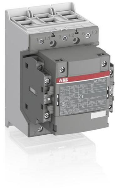
3-фазный Контакттор подходит для различных приложений, таких как запуск двигателя, изоляция, бай-пасс и дистрибуции приложений, максимум до 690 в. эксплуатируется с широким напряжением диапазон 48-130 В, 50/60 Гц и постоянного тока
