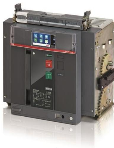
Движущиеся части С. САЧЕ выключатель EMAX2 E4.2B 2500 трехполюсные с полупроводниковым выхода В переменного тока экип/г/штрих-LSIG P 2500 оснащена: 4 вспомогательный контакт и С. выключатель в положение открыто-закрыто
